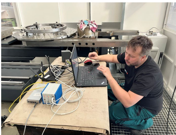
Obr. 19 Dynamické zkoušky – vlevo, příprava měřicí aparatury – vpravo na stroji MCG1000.
