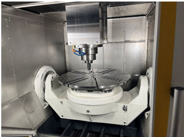
Obr. 17 Zkoušky kruhové interpolace na stroji MCG1000.
