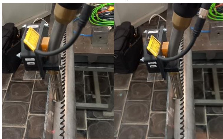
Obr. 10. Test vyhledávání koutu pomocí laserové metody (vlevo poloha bez korekce, vpravo s korekcí)
